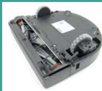
**NELLA PARTE INFERIORE** del robot, ci sono le spazzole di pulizia e di aspirazione.
