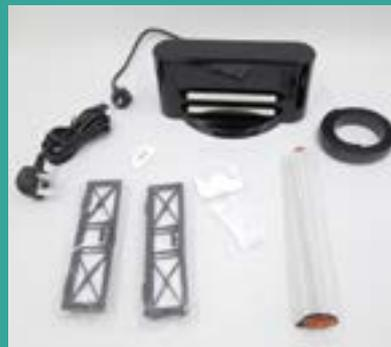
**IN ALTO** la base di ricarica del robot, quindi i filtri del motore, la spazzola di aspirazione, la banda magnetica, il pennello per pulizia e manutenzione.
